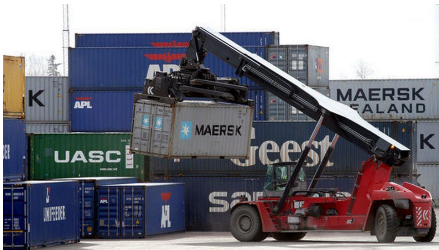
Figur 3.2 Reachstaker i aktion i Eskilstuna-terminalen i Stockholm. Kilde: Eskilstuna Logistik
